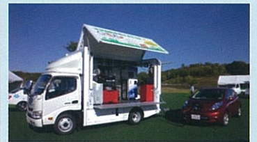
走行用エンジンで発電する 自己完結型EV用急速充電車 株式会社三輪タイヤ
