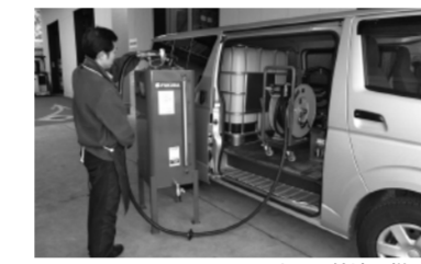
IBCコンテナからの給油の様子
