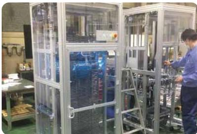
設備・製品等の試作開発で培ってきたアイデアと技術力を掛け合わせ、スーパーやホームセンター等で買い物カゴやカートについたウイルスを除去する装置を開発。積み重なったカゴを一つずつ持ち上げ、紫外線を照射することで、多くの人が手を触れる取っ手部分などを中心に、60個を約12分で99.9%以上、自動的に除菌することが可能となる。
