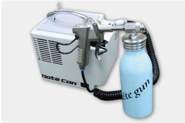
新型コロナウイルス感染症の拡大により、除菌に対するニーズが高まっている中、独自開発した極小型（約6kg）・低騒音（43dB）・省エネコンプレッサーを使って、新たに軽量で持ち運びが容易な液体噴霧機「note gun misty（モテガンミスティ）」を提案する。消毒・除菌液（エタノールやオゾン水など）を入れたボトルをガン型スプレーに装着後、レバーを握るだけで消毒・除菌液をミスト状に連続噴霧できる。噴霧量≒0.3cc/secであり、手動の霧吹き型スプレーを用いての消毒作業に比べ“短時間”で“広範囲”を“ムラなく”除菌でき、作業者の負担が大幅に低減する。広範囲をムラなく除菌できることにより安心感も高まる。
