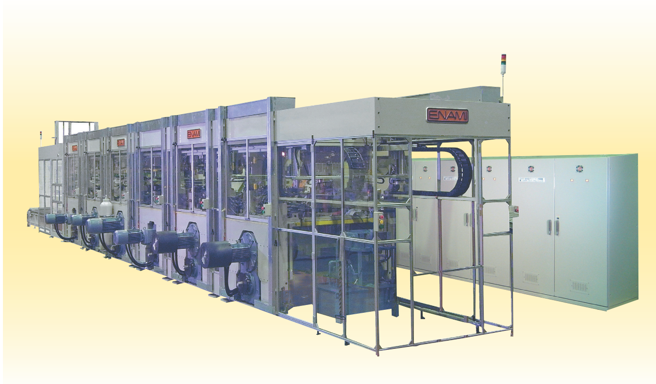
縦・横・高さの寸法の違う箱(1849種類)を金型を交換せずに連続自動生産するプレスライン((株)エナミ精機)
