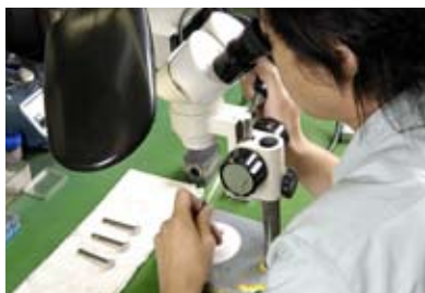
一つひとつ手磨きで仕上げる金型。
