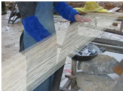
③ 糸を揃えて並べて糊をつけ、炭をおこして乾燥させる。(裂けた箇所を繋いだり、毛羽立ちを防ぐことで糸をなめらかにし、織りやすくするため)
