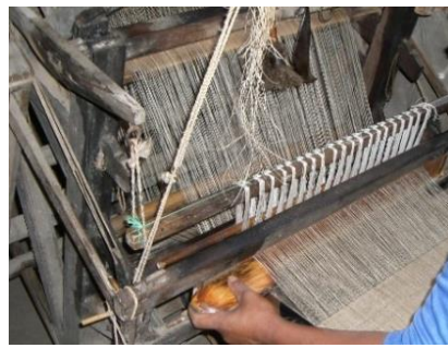
④ 上下にタテ糸を分ける器具である綜紉(そうこう)にタテ糸を通す。機に糸を通す箴(おさ)にヨコ糸を通し、織り始める。
