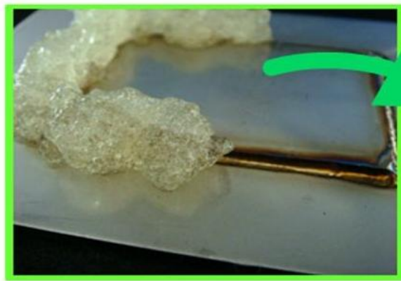
溶接を施した板にエスピュアSJジェルを塗布した状態
