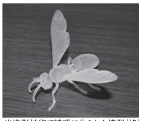
光造形技術で精巧に作られた模型(蜂)
