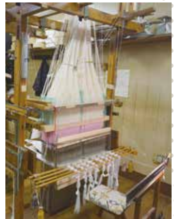
「綜統」とは織機の心臓部にあたり、多種多様な織物に対応するための重要な装置です。受け継がれる熟練の技術はこれからも西陣織を支えています。
