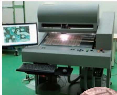
プリント基板の検査に欠かせない「確認機」。同社製は高機能でオペレーターにも優しい。
